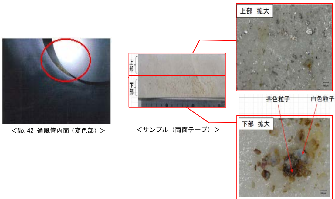
図-36 変色部のサンプル外観 (No. 42 通風管)
