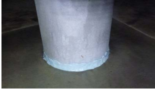
図-4 3 レプリカ採取用樹脂による型取り
